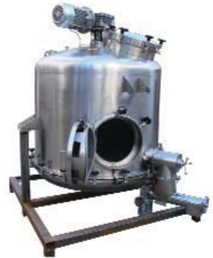
Нутч-фильтр. Выполняет задачи загрузки, перемешивания, фильтрации и выгрузки
