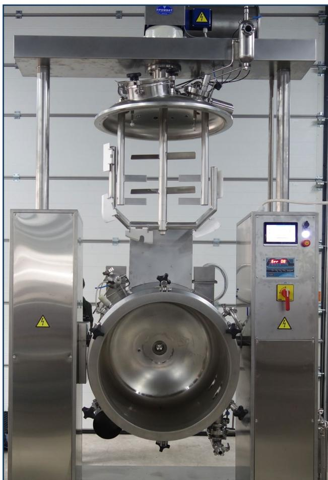
Реактор РСГПП-200 ВК в положении поднятой крышки и повернутым корпусом. Эти опции дают 100 % гарантию мойки корпуса и полную выгрузку готового продукта высокой вязкости
